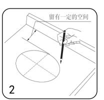
使用安装用纸样,按照安装 用纸样中的使用方法确定出 洗面器在台面上的裁切线及 安装位置。
