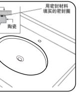
连接进水和排水管件。 注意: 龙头与进水、排水件 的连接要牢固,否则会有漏 水的可能,安装后请务必确 认无漏水等不良状况。
