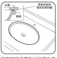
待到硅胶类密封材料硬化后, 将龙头按照其说明书上的要 求及步骤安装到洗面器上。 警告:必须使用硅胶类密封 材料;绝对禁止使用环氧树 脂胶或硬化后体积变大的密 封材料,且由此而造成的损 失我公司概不负责。
