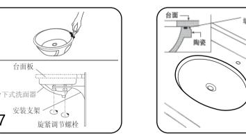
检查校验后,把洗面器放平 ,在洗面器边缘槽口填上<mark>硅</mark> 胶类密封材料。再把洗面器 小心地放到台面下,对准安 装口,与先前的记号相校准 并向上压紧, 旋紧铁支架调 节螺栓,使洗面器与台面紧 密连接。
