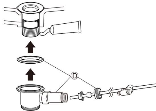
在排水头的螺纹部分涂抹接缝密封胶或缠绕生料带，然后将密封圈和杠杆孔从洗面器下面组装到排水头上。调节安装杠杆螺纹孔的方向，使其正对墙壁。将杠杆插入杠杆螺纹孔并旋紧螺母。
