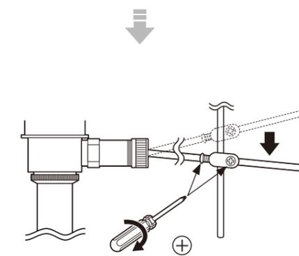
如图所示：先将杠杆穿过连接滑块，然后用连接螺母将提拉杆与连接杆固定，再调整连接滑块的位置，使杠杆处于合适的位置并固定。
