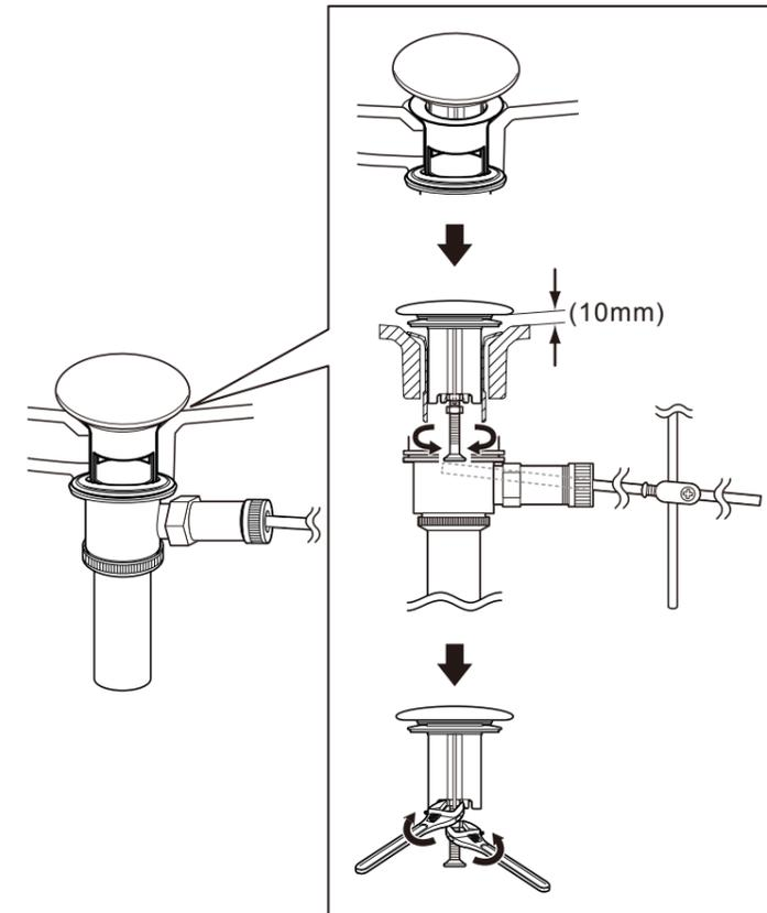
调节止水塞的螺钉与螺母，使止水塞与洗面器的距离为10mm。
