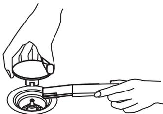
4. 将按钮安装到排水口的金具中（按下去时，会发出“咔嚓”声）。
