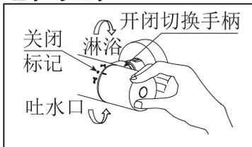
3. 若将开闭切换手柄向自身方向旋转，使从吐水口中出水。若向后旋转，则从淋浴器中出水。旋到极限位置时，出水量达到最大。欲止住吐水，请将开闭切换手柄的标线对准本体的关闭标记。
