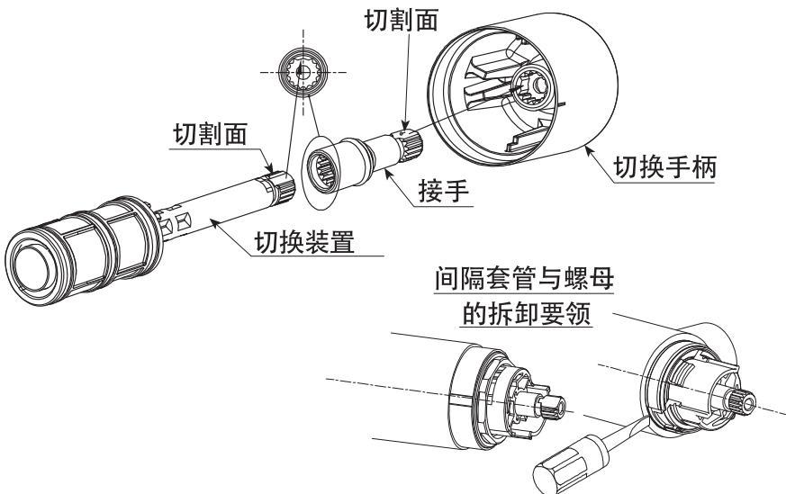
※ 无法拆下间隔套管时,
