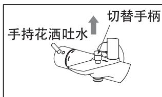
若将切换手柄向自身方向旋转，则为手持花洒吐水(TBW01301\*场合下为吐水口吐水)，若向后旋转，则为淋浴花洒吐水；旋到极限位置时，出水量达到最大。
