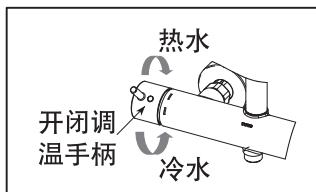
根据希望的出水温度调节手柄。(红色标识为热水侧, 蓝色标识为冷水侧; 冷热水调温角度约为 90°)
