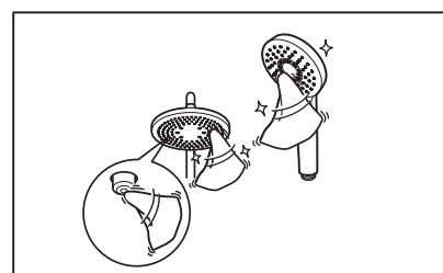
若使用时出现水线不均匀的现象，可用毛巾轻轻擦拭散水板上的小硅胶吐水口，清除异物。
