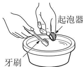
注意：●使用专用工具拆卸起泡器以免划伤手指、起泡器螺纹。
